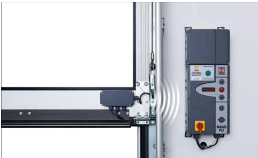
Радиопредавател за предаване на сигнали от платното през Bluetooth за управление (без спирален кабел), електрозахранване чрез мощна батерия; допълнително монтиращи се компоненти: оптични сензори LE (low energy), фотоклетка с изпреварващо действие VL1-LE / VL2-LE, омов контакт 8k2, датчик „скъсано въже“, контакт за вградена врата, контакт за заключване през нощта
